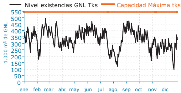
Niveles diarios EXISTENCIAS en tanques de GNL
